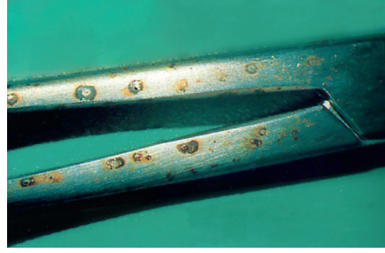
B.10 Şekil - Sterilizasyon buharındaki pas parçacıkları kaynaklı çukurlaşma başlangıcı
