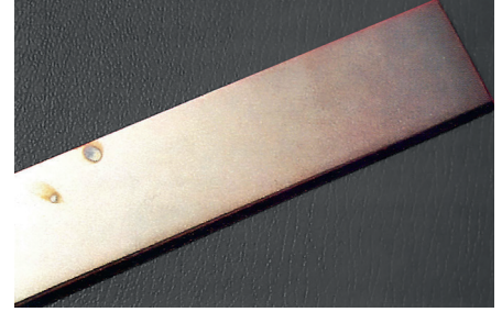
B.5 Şekil - Keski üzerinde oluşmuş çukur korozyonu
